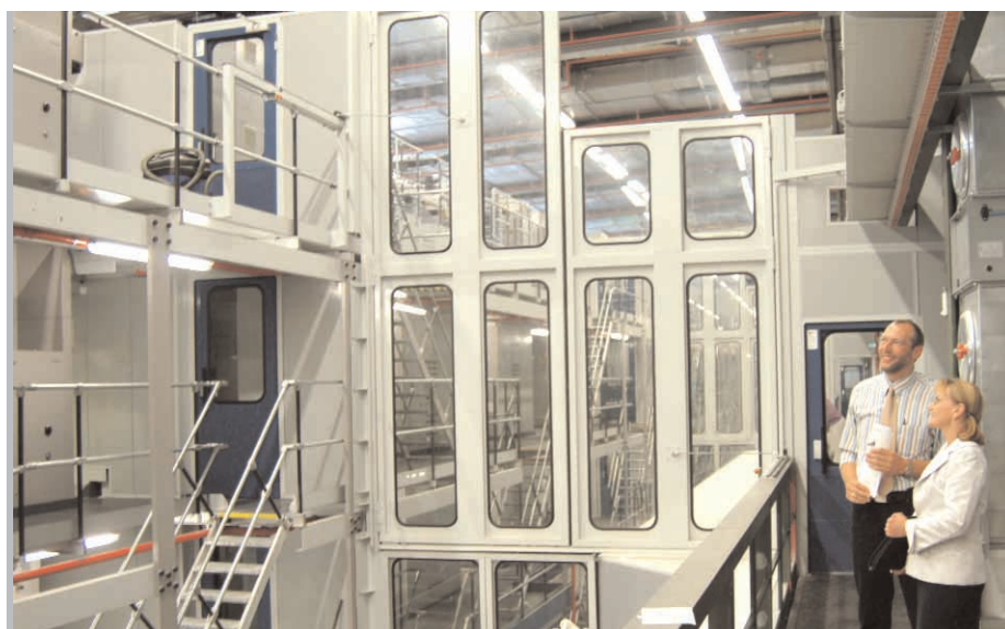
Sicherheitsingenieur John Klagge (Axel Springer AG) mit Hanna Kazmierczak (Faist) auf der Besuchergalerie, die über den Maschinenleitständen verläuft. Links die Sektionaltrennung mit Türen im Bereich der Galerie, daneben der verglaste und teilweise schwenkbare Bereich.
