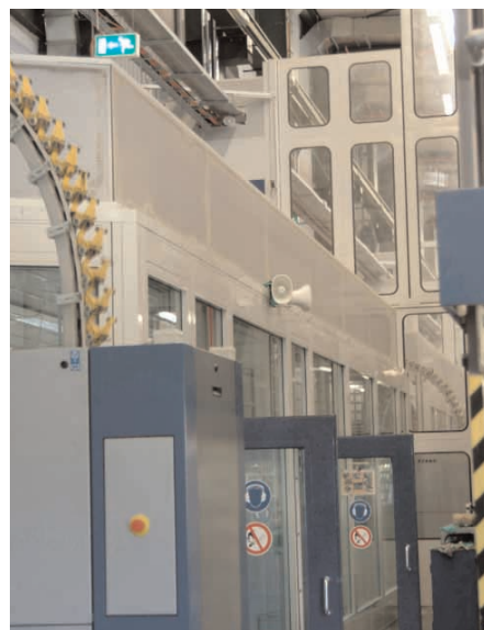
Besonders schallgedämmt: die Leitstandkabinen über denen die Besuchergalerie verläuft; re. oben eine Sektionalabtrennungen.
