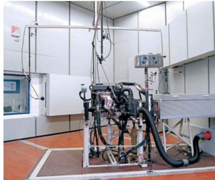
Akustischer Messraum für Fahrzeugkomponenten: akustischer Motorenprüfstand; FEV, Aachen Acoustic measurement room for component measurements: acoustic engine test rig; FEV, Aachen, Germany
