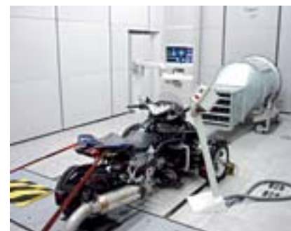
Akustischer Messraum für Gesamtfahrzeug- messungen; BRP-Rotax, Österreich Acoustic measurement room for full vehicle measurements; BRP-Rotax, Austria
