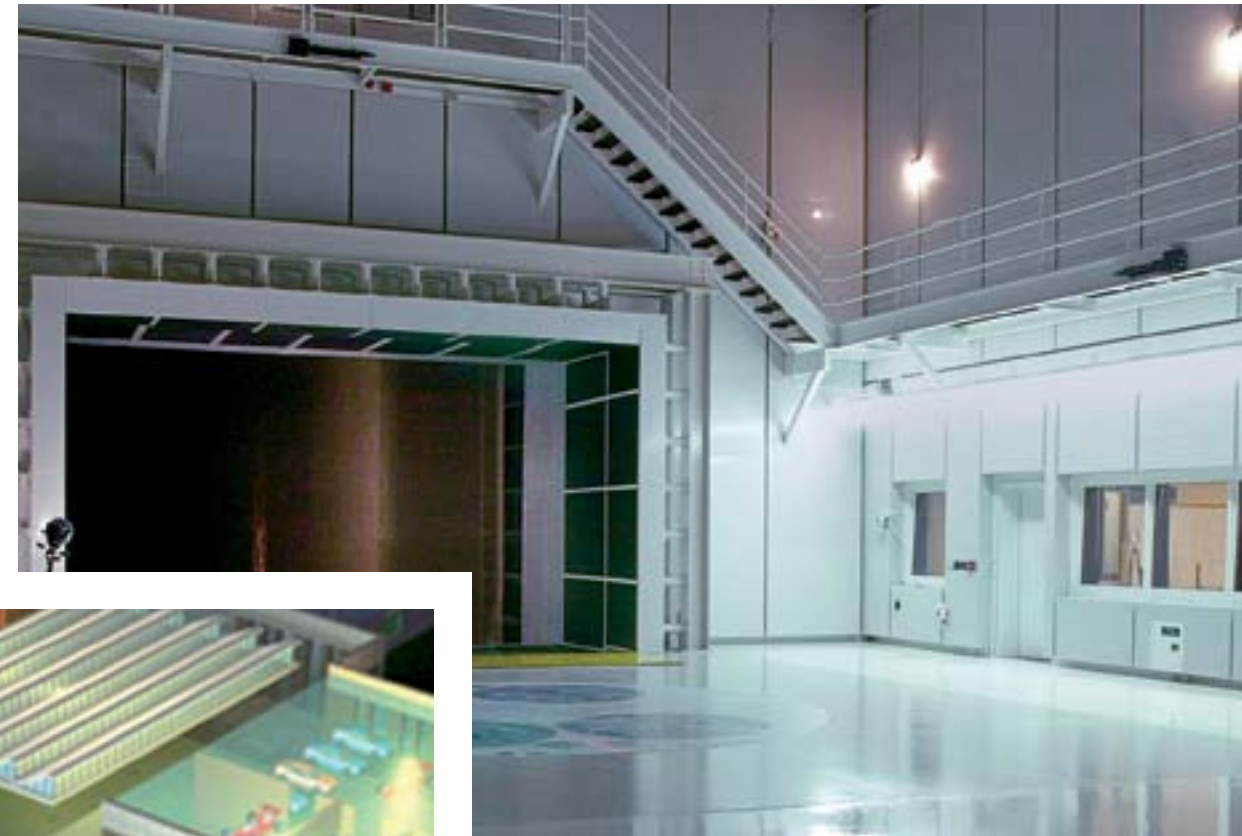
Akustische Auskleidung des Plenums und der Düse; (DaimlerChrysler, Auburn Hills, USA) Anechoic lining of test section and nozzle; (DaimlerChrysler, Auburn Hills, USA)
