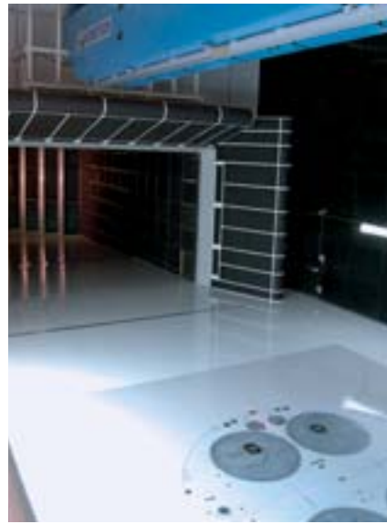
Akustische Behandlung von Kollektor und Diffusor; PSA Peugeot Citroën, Frankreich Acoustic treatment of collector and diffuser; PSA Peugeot Citroën, France
