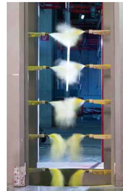
Automatisch richtig dosiert: die Pulverwolke ist entscheidend für die Qualität der Oberfläche.
