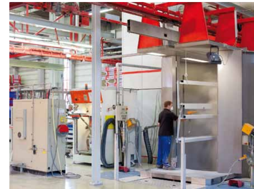
Als Ergänzung zur vollautomatischen Beschichtung wird das Pulver bei geometrisch anspruchsvollen Teilen manuell aufgetragen.
