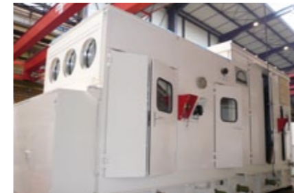
Звукоизоляционный блок для газовой турбины THM; MAN Diesel & Turbo SE
