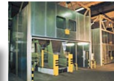
Schallschutzkabine für Strahlanlage, Schalldämmung 25 dB Georg Fischer, D-Singen
