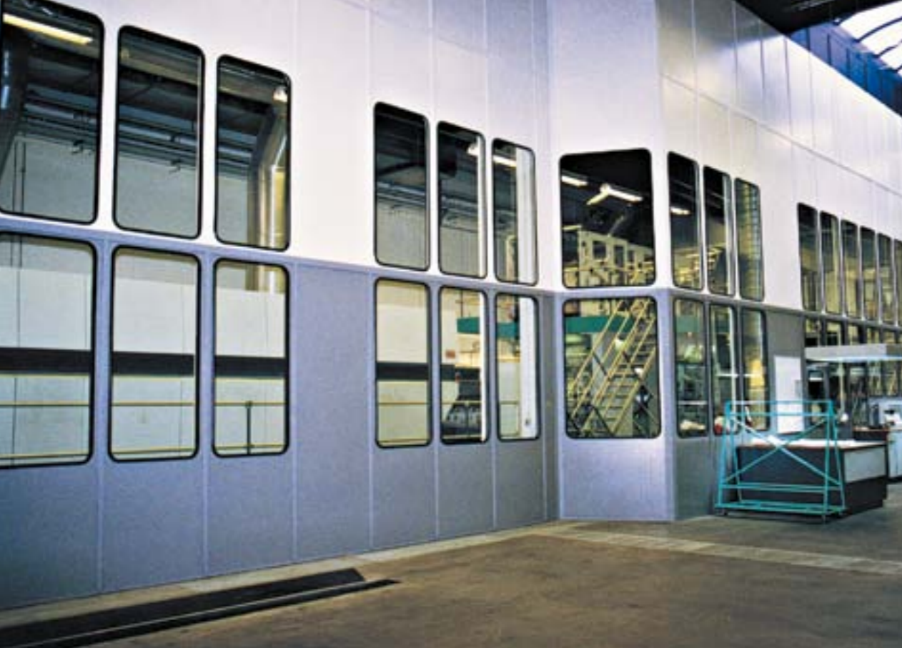
Schallschutzwand für eine Akzidenzdruckmaschine, Schalldämmung 25 dB Stibo Graphic, DK-Horsens
